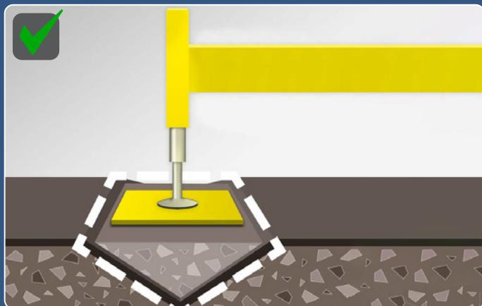
As placas de apoio devem ser sempre usadas em plataformas elevatórias móveis de trabalho de braço/lança quando totalmente suportadas pelos seus estabilizadores.
