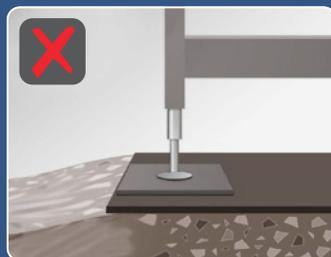
**Les plaques de calage doivent toujours être utilisées pour les PEMP à flèche (téléscopique) équipées de stabilisateurs.**
