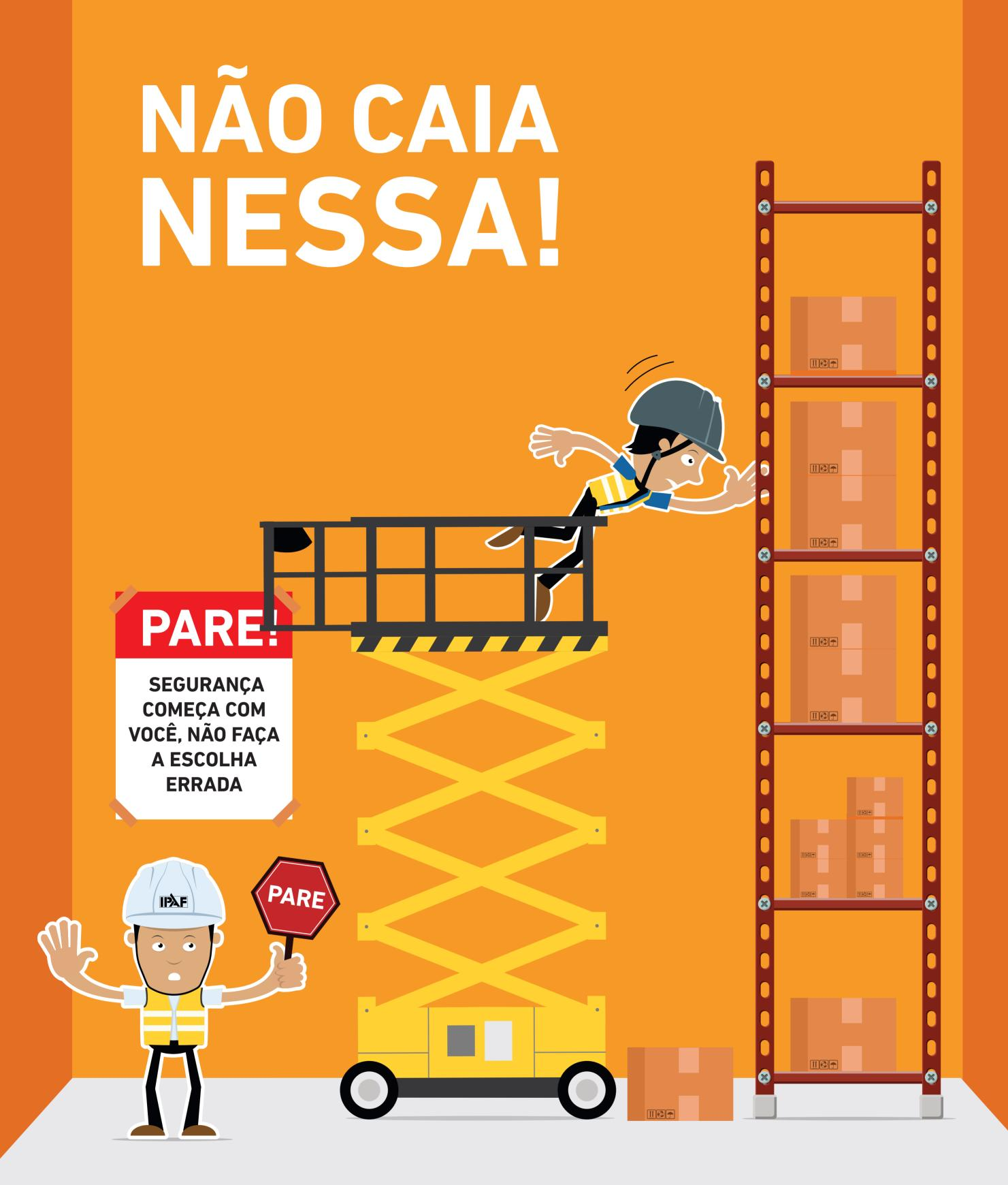
POSICIONE A SUA PEMT/PTA CORRETAMENTE E SEMPRE FIQUE DENTRO DAS GRADES DE PROTEÇÃO DA PLATAFORMA COM OS DOIS PÉS NO PISO DA PLATAFORMA
