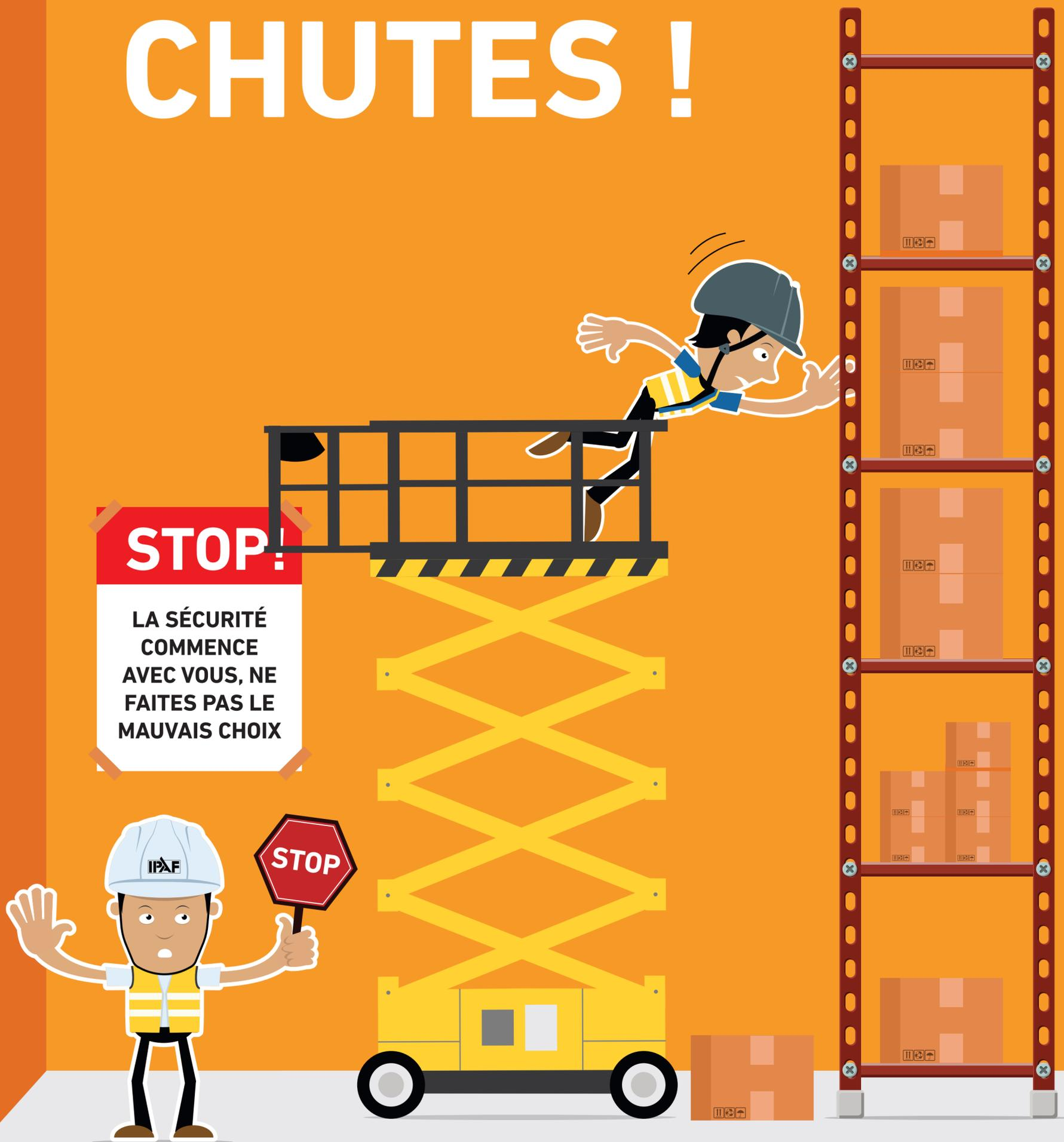
**POSITIONNEZ CORRECTEMENT VOTRE PEMP ET RESTEZ TOUJOURS À L'INTÉRIEUR DES GARDE-CORPS DE LA PLATEFORME, LES DEUX PIEDS SUR LE SOL DE LA PLATEFORME**
