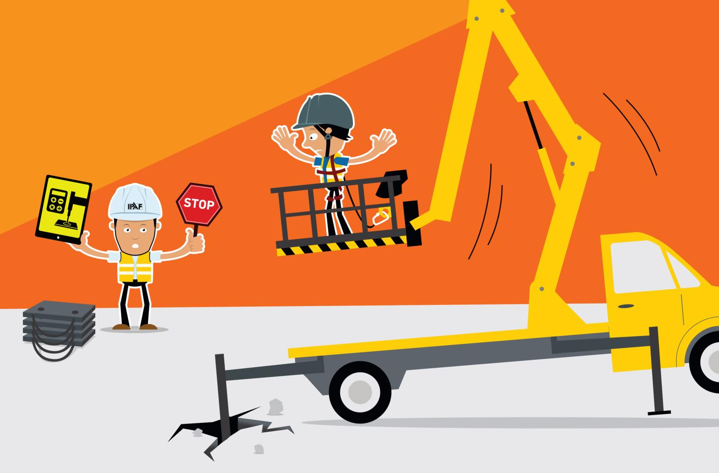
CONTROLLA SEMPRE IL CARICO AL SUOLO E UTILIZZA IL CALCOLATORE DELLE PIASTRE DI APPOGGIO IPAF PER
