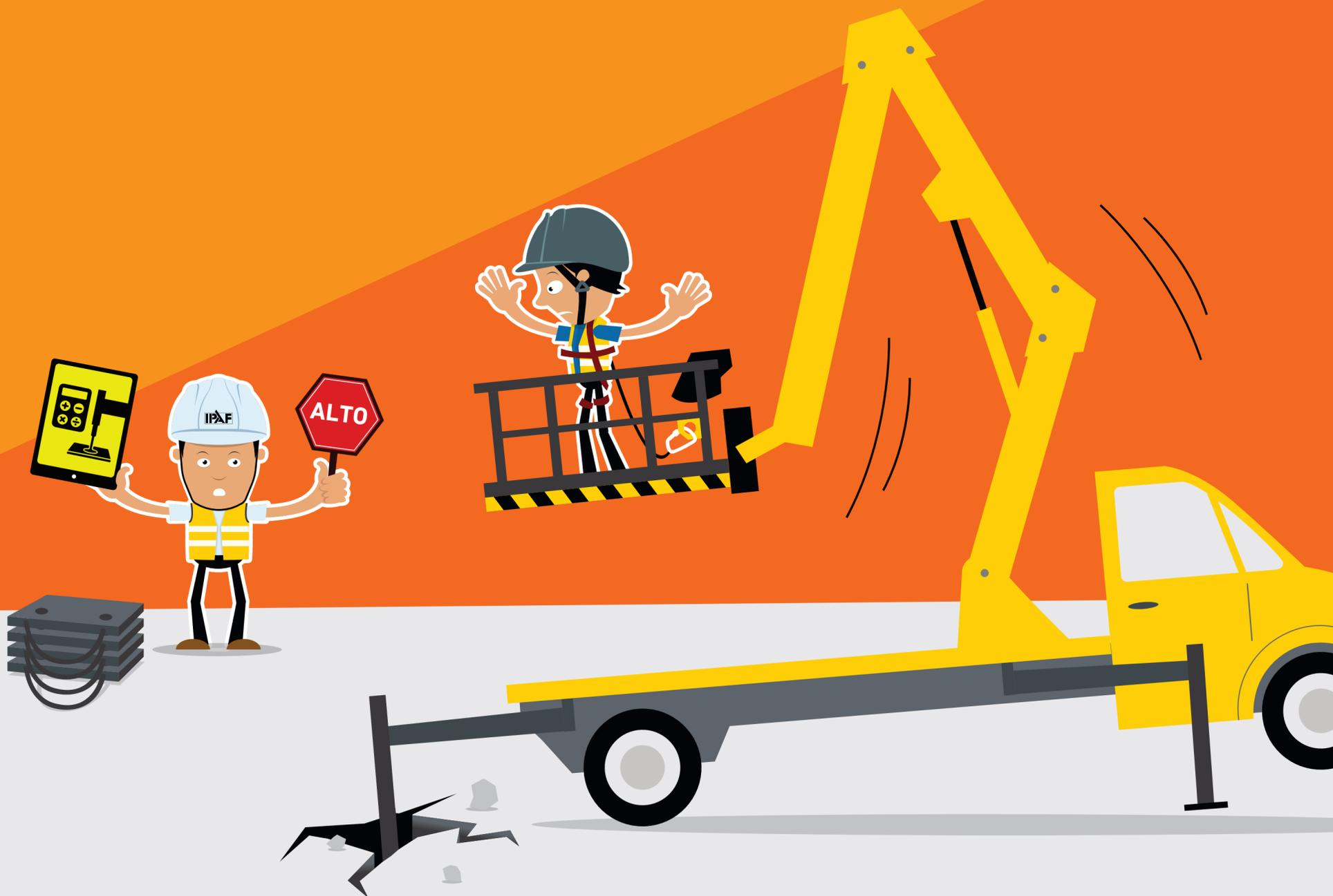
COMPRUEBE SIEMPRE LA CARGA SOBRE EL SUELO Y UTILICE LA CALCULADORA DE PLACAS DE APOYO DE IPAF PARA
