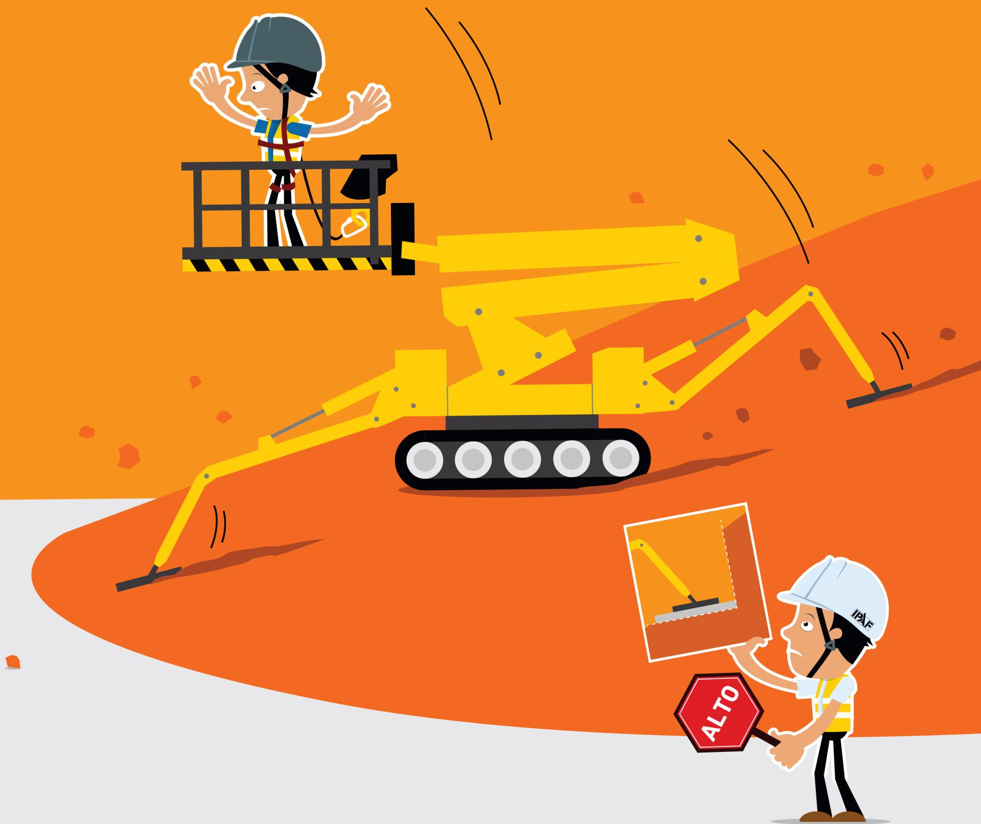
**ESTABILIZADORES Y PLACAS DE APOYO DEBEN ESTAR NIVELADOS Y CON UN SUELO ESTABLE**
