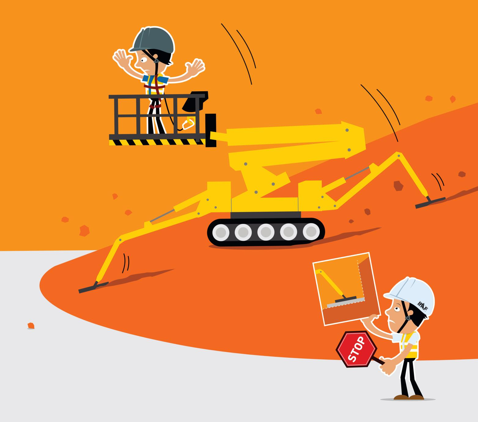
OUTRIGGERS AND SPREADER PADS MUST BE ON LEVEL AND STABLE GROUND
