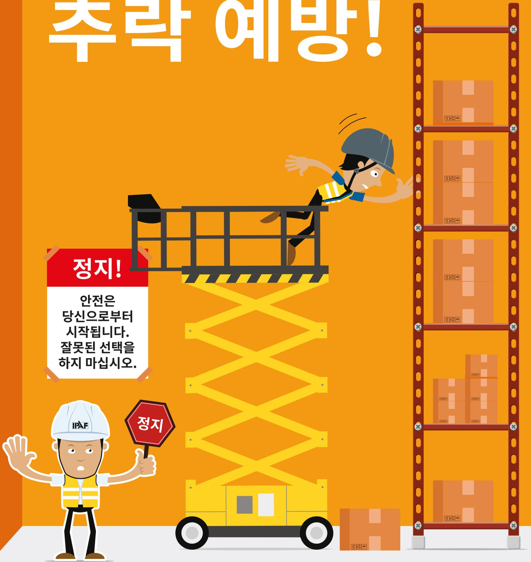
고소작업대를 올바르게 배치하고 두 발이 작업대 바닥에 닿은 상태로 항상 작업대 난간 안에 있어야 합니다.
