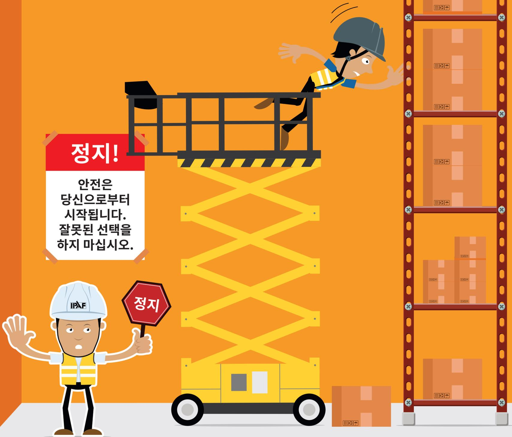
고소작업대를 올바르게 배치하고 두 발이 작업대 바닥에 닿은 상태로 항상 작업대 난간 안에 있어야 합니다.
