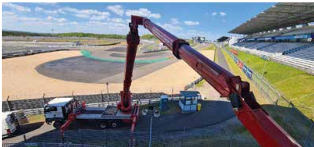
Auf der Zielgeraden: Um am Nürburgring entlang der Zielgeraden die Werbebanner an den Tribünen auszuwechseln, wurde diese Ruthmann T540 von Castell auf die Rennstrecke geschickt. Entscheidend für den Einsatz dieser Maschine waren einerseits ihre hohe seitliche Reichweite, andererseits die 600 kg Traglast im Nahbereich. (Bild: Castell)
