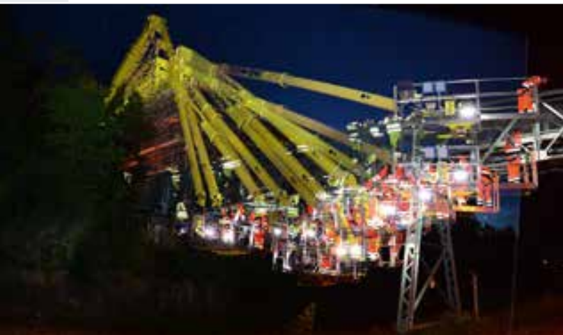
Lichteffekte: Für Wartungsarbeiten an der Fußgängerbrücke über die Bahnleihe reichte der Ruthmann Steiger T 510 HF von Schwenk mit seinen 33 Metern Reichweite und 600 kg Traglast selbst an die entferntesten Stellen. Dabei bewegte der erfahrene Bühnenführer den Arbeitskorb zielgenau zwischen den einzelnen Brückenabschnitten, so dass innerhalb weniger Nachtstunden die gesamte Inspektion abgeschlossen war und die Gleissperrung termingerecht wieder aufgehoben wurde. (Bild: Schwenk)
