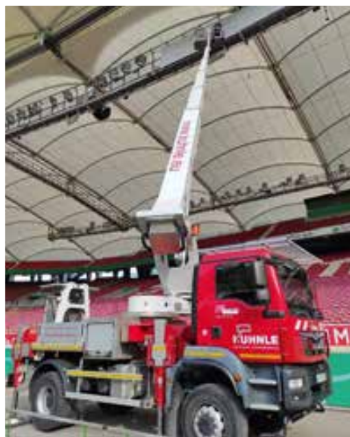
Namenswechsel: Nachdem das Heimstadion des VfB Stuttgart im vorigen Sommer von „Mercedes-Benz-Arena“ auf „MHP Arena“ umbenannt worden war, mussten am Dach auch die Logos des früheren Inhabers der Namensrechte abgebaut werden. Dazu fuhr die 18-Tonnen-Lkw-Arbeitsbühne von Kuhnle vor der Tribüne vor, eine Palfinger P 370KS mit 37 m Arbeitshöhe – rechtzeitig vor dem DFB Pokalspiel gegen Union Berlin. (Bild: Kuhnle)
